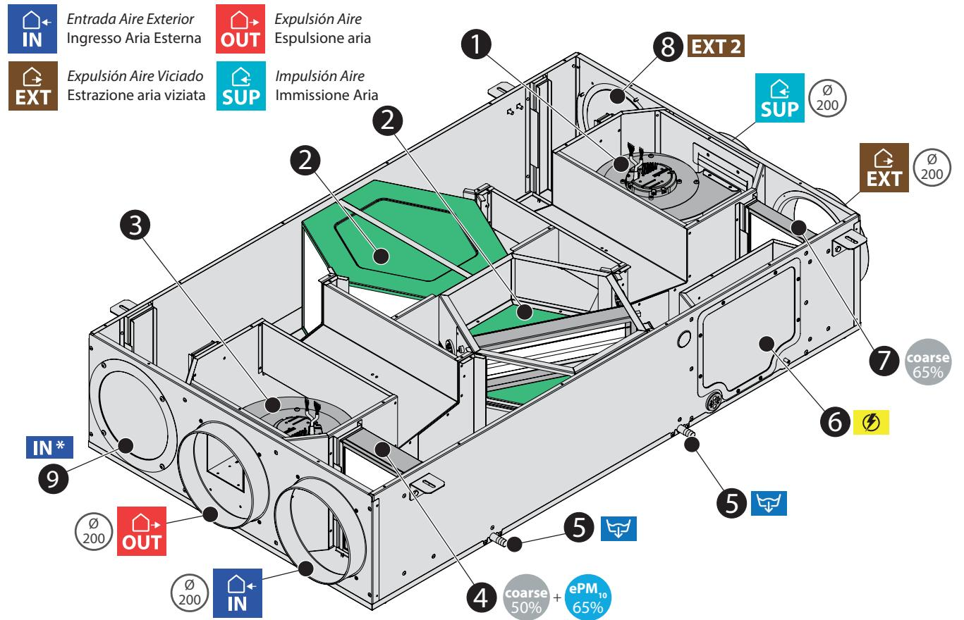
(\*) Para la Toma de Aire Exterior es posible elegir entre la posición por defecto y la posición ALTERNATIVA, intercambiando la posición del collarín y del filtro de aire.
